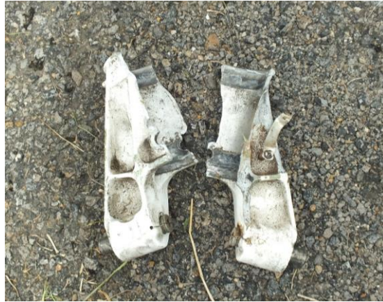
Condición Final: Trunnion Tren Principal Izquierdo (L)
