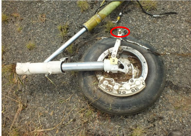
Condición Final: Tren Principal Izquierdo (L) / Fractura Perno (Bushing) que sujeta la Tijera (Link Assy Main Gear Strut)
